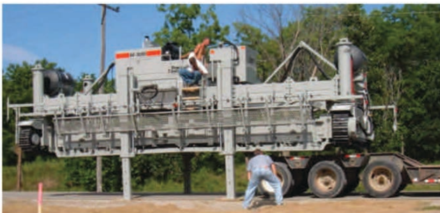
Погрузка бетоноукладчика на полуприцеп при помощи гидравлических опорных домкратов
