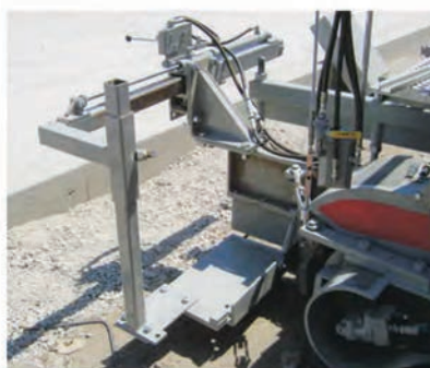
Опциональный гидравлический механизм бокового погружения арматурных стержней. Доступен в ручном исполнении
