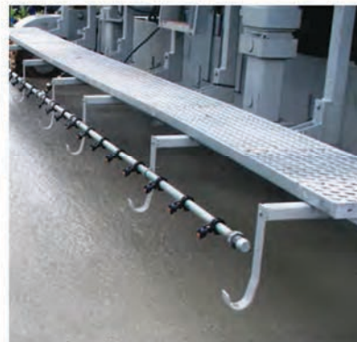
Крюки для крепления заглаживающей мешковины и опциональная система распыления воды
