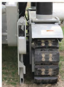
Опциональный гидравлический механизм бокового погружения арматурных стержней. Доступен в ручном исполнении
